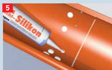
5 Nitterne skal yderligere tætnes på indersiden.
