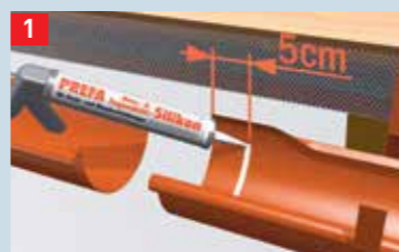
1 På den rengjorte og tørre tagrende påføres 50 mm fra enden en stribe (ca 8 mm tyk) PREFA silikone.
