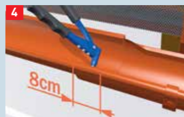
4 Renden drejes ind i hinanden, en nitte sættes indvendig på tagrendeulsten.
