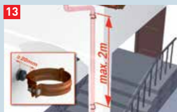
13 Rørholdere monteres på muren. Til hvert enkelt nedløbsrør monteres mindst 2 rørholdere
