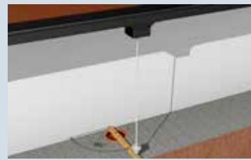
1 PREFA kvadratrør tudstykke placeres lodret over kloaktilslutningen.
