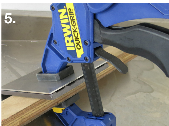
5. Brug evt. en skruetvinge til at holde flise/klinke fast på klinkepladen under tørringen af montagelimen.
